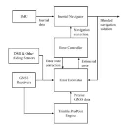
Figure 3: Trimble<sup>®</sup> Applanix IN-Fusion+<sup>TM</sup> Architecture
